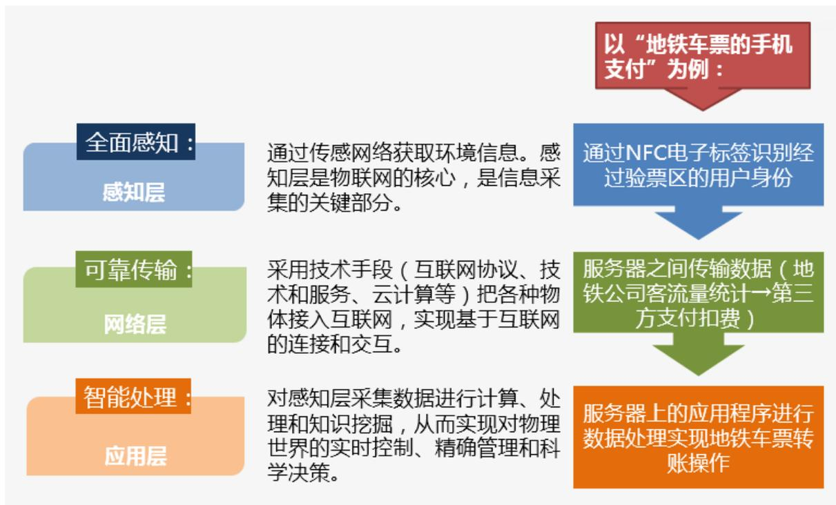
前述三个层面的内容，以地铁票的手机支付为例，体现为如下三个流程：用户手持移动设备经过验票区，验票装置通过移动设备的 NFC 电子标签识别用户身份；地铁公司、第三方
